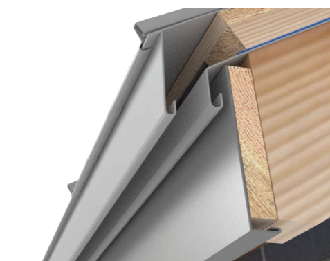
ABB. 11 Über die Traufe hinausgeschobenes Start-Paneele
